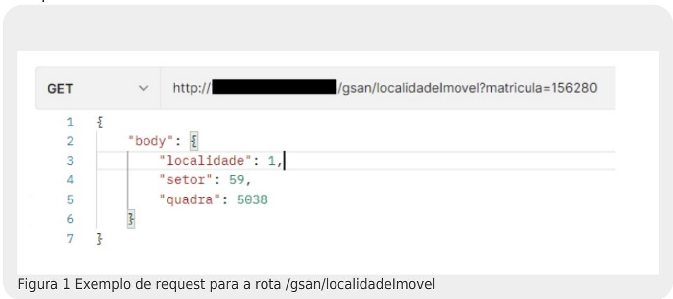
Figura 1 Exemplo de request para a rota /gsan/localidademovel
