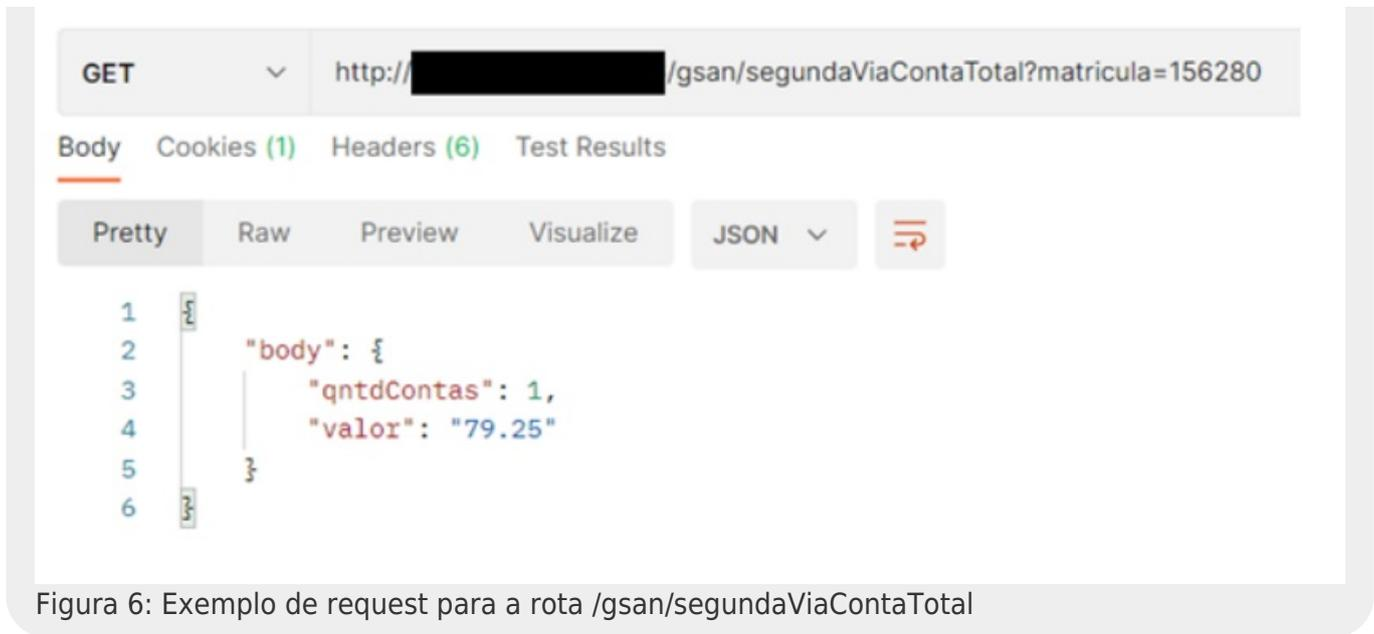
Figura 6: Exemplo de request para a rota /gsan/segundaViaContaTotal
