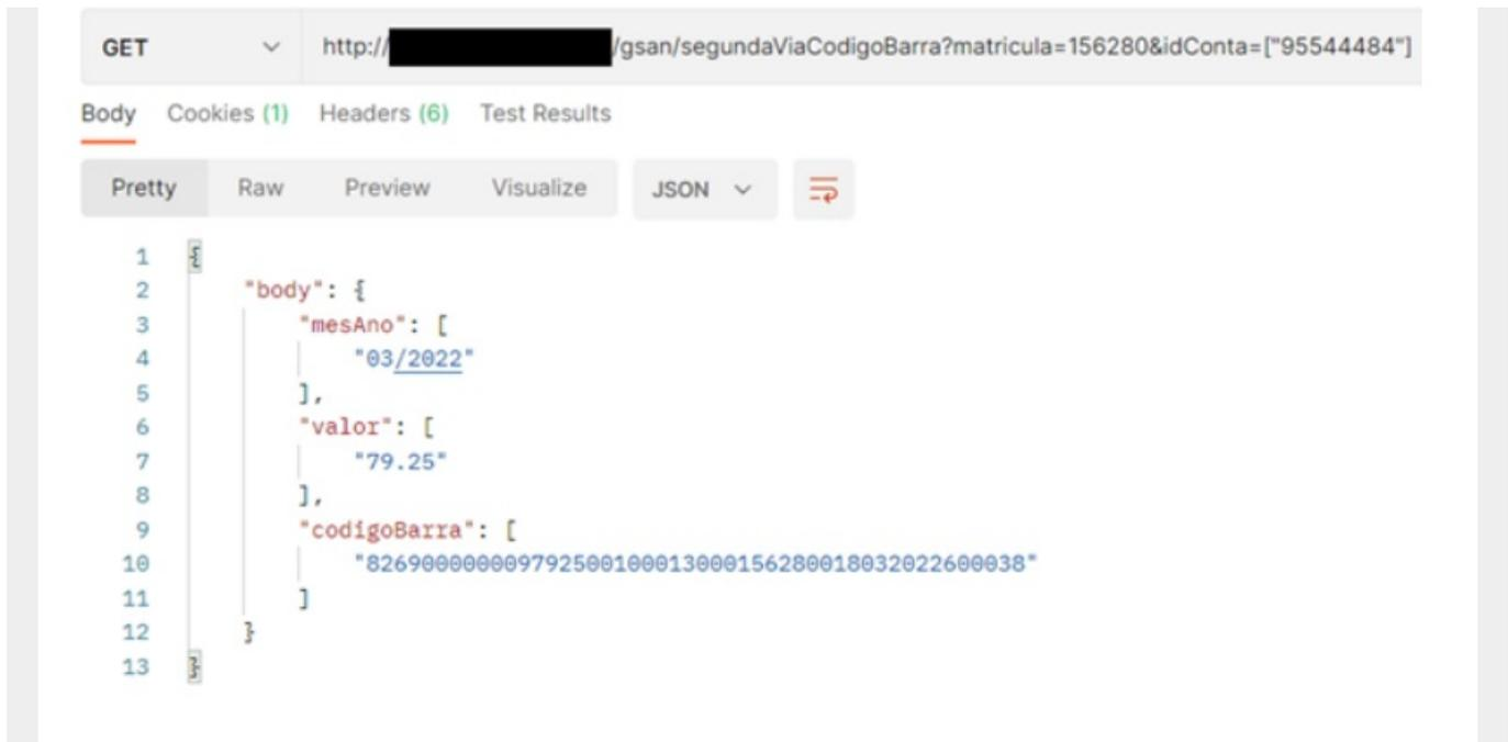
Figura 7: Exemplo de request para a rota /gsan/segundaViaCodigoBarra
