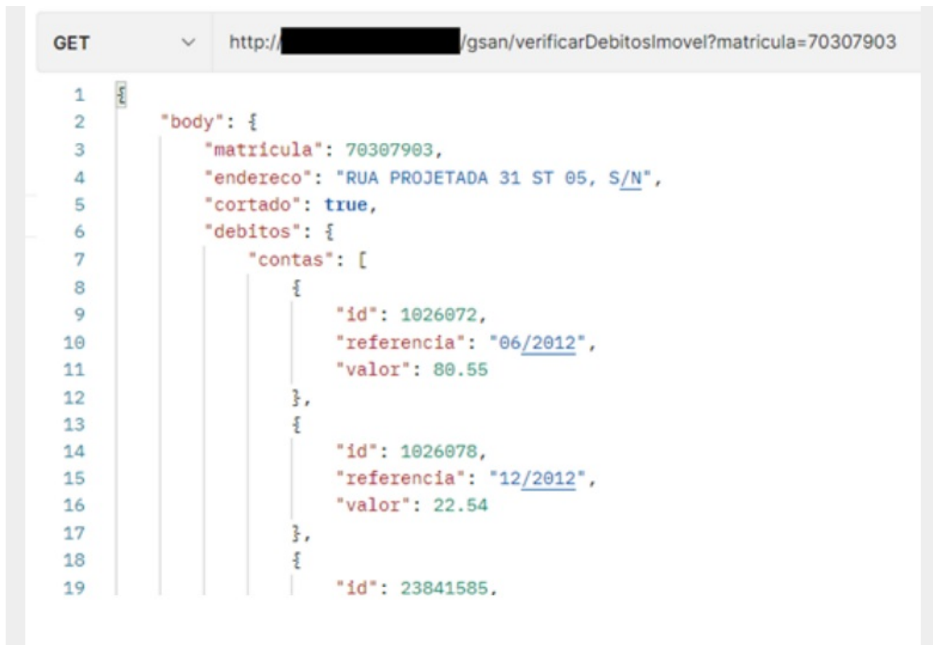
Figura 14.1 - Exemplo de request para a rota /gsan/verificarDebitosImovel
