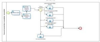
Figura 13: Processo - Consistir Leitura e Anormalidade: Micromedição
